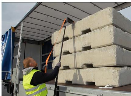
**2) MULTI STICK:** El Multi-Stick es una herramienta para que los conductores y cargadores instalen ángulos de protección sin necesidad de trepar sobre los productos evitando posibles accidentes haciendo que los cargadores no puedan caerse del camión y permitiendo hacer todo el trabajo de estiba desde el suelo.
