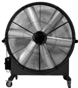
• **Ventilador industrial Anemoi AIRGO:** Está pensado para ser portátil. Pese a su altura de 1,80 m se trata de ventilador fácil de transportar, puesto que incorpora ruedas y un manillar. Con una potencia de 1500W, el aire que genera llega hasta a 30m de distancia.
